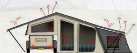
Das besondere Cabriodach sorgt dafür, dass warme Luft einen Ausweg nach draußen findet. Es ist mit dunklem und wärmeabweisendem Moskitogaze ausgestattet. Die Seitenabdeckungen bilden eine Barriere gegen warme Sonnenstrahlen.
